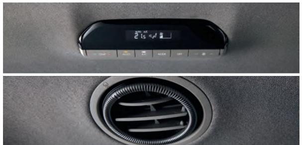
Система вентиляции в зоне третьего ряда
