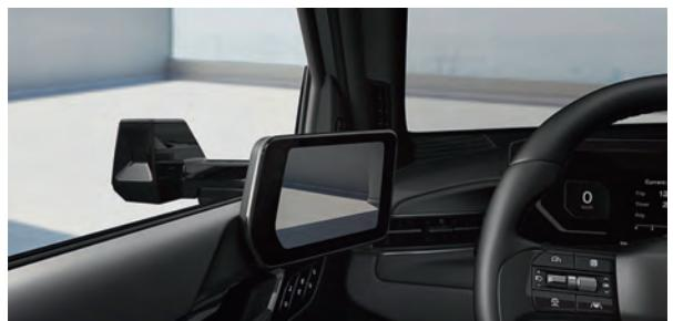
Боковые камеры заднего обзора с дополнительными экранами 7"
