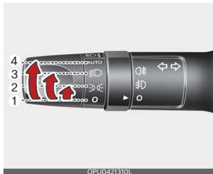
У переключателя освещения есть положение работы передних фар и положение работы стоп-сигналов. Для управления фарами поверните кнопку на конце рычага в одно из следующих положений:
