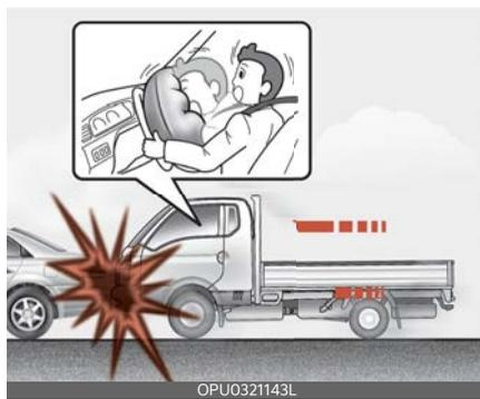
Передние подушки безопасности предназначены для надувания при лобовом столкновении в зависимости от интенсивности, скорости или угла удара.
