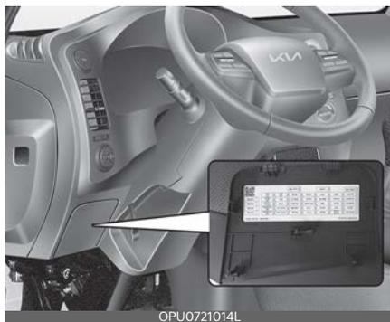
На внутренней стороне крышки панели предохранителей/реле находится табличка с указанием наименования и номинальных параметров предохранителей/реле.
