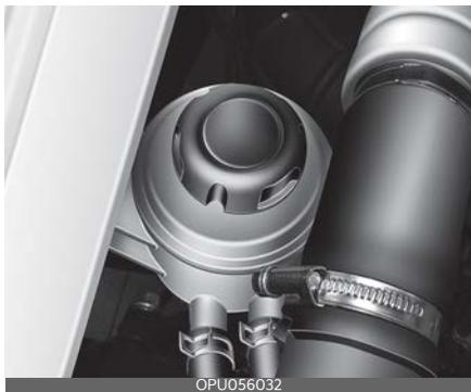
Периодически проверяйте уровень жидкости в бачке усилителя руля, когда автомобиль находится на ровной поверхности. Уровень жидкости при нормальной температуре должен находиться в пределах между отметками «MAX» (Макс.) и «MIN» (Мин.), нанесенными на боковой части бачка.
