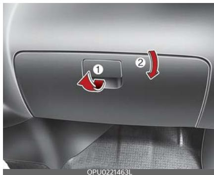
Чтобы открыть бардачок, потяните за ручку (1), после чего он откроется автоматически (2). Закройте перчаточный ящик после использования.
