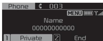
1. Private (Приватный режим): переключение голосового звонка с системы громкой связи автомобиля на устройство с Bluetooth®.
