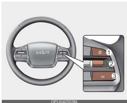
Режимы ЖК-дисплея можно изменить с помощью кнопок управления на рулевом колесе.
