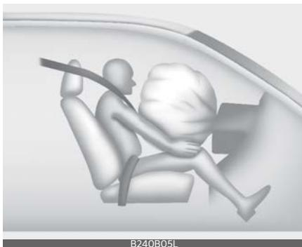
После полного раскрытия подушка безопасности сразу же начинает сдуваться, позволяя водителю видеть ситуацию на дороге, а также работать рулем и использовать другие органы управления.
