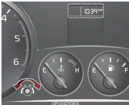
При каждом отсоединении клемм аккумулятора или соответствующих предохранителей необходимо заново устанавливать время.
