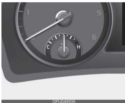
Этот датчик показывает температуру охлаждающей жидкости двигателя, когда замок зажигания находится в положении «ON» (Вкл.).
