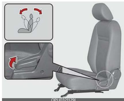
Чтобы отрегулировать угол наклона спинки сиденья, выполните указанные далее действия:
