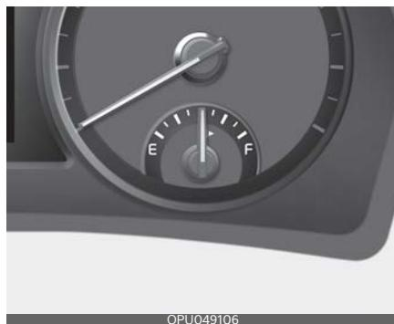
Этим указателем отображается примерное количество топлива в топливном баке.
