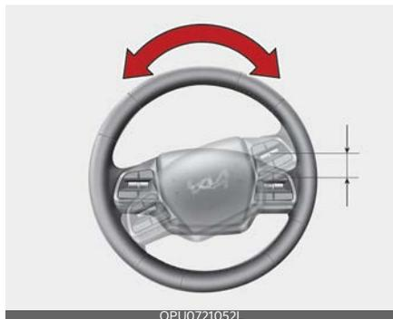
Для проверки свободного хода рулевого колеса остановите автомобиль, чтобы колеса были направлены прямо вперед, и плавно подвигайте рулевое колесо вперед и назад. Не давите на руль и отмечайте все изменения сопротивления, которые обозначают пределы свободного хода. Если свободный ход больше стандартного значения, следует проверить систему в специализированной мастерской. Kia рекомендует обратиться к официальному дилеру Kia или партнерской сервисной компании.
