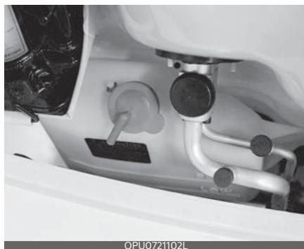
Проверьте состояние и соединения всех шлангов систем охлаждения и обогрева. Замените все вздутые или изношенные шланги.
