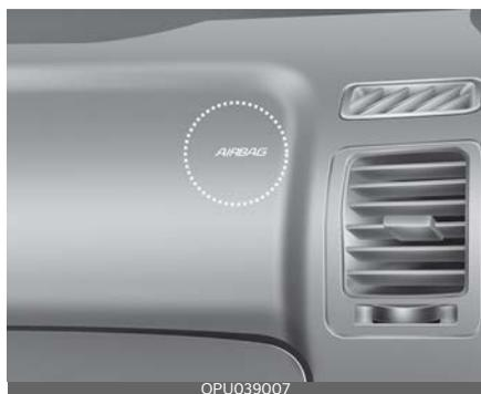
Система пассивной безопасности состоит из подушек безопасности, установленных под накладками в центре рулевого колеса и на передней панели со стороны пассажира, над перчаточным ящиком.
