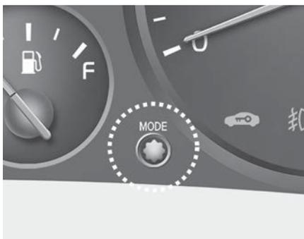
Можно выбрать одометр, счетчик пробега А, счетчик пробега В, запас хода по топливу и средний расход топлива, нажав кнопку MODE счетчика пробега.
