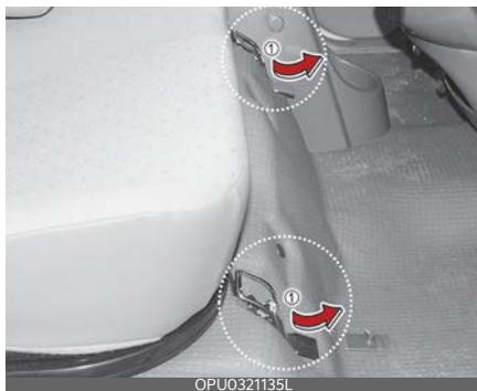
3. Поднимите пассажирское сиденье и зафиксируйте ремень на анкере под сиденьем, чтобы закрепить его. Отрегулируйте угол подъема сиденья с помощью отверстий на ремне.
