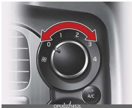
Предусмотрены четыре (4) регулируемые скорости вентилятора, которые увеличиваются по мере увеличения числа. Для того чтобы вентилятор работал, замок зажигания должен находиться в положении «ON» (Вкл.)
