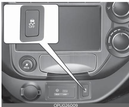
Система электронного контроля устойчивости (ESC) предназначена для стабилизации автомобиля во время выполнения маневров поворота. Система ESC проверяет направление, в котором поворачивается рулевое колесо, и направление, в котором автомобиль движется на самом деле. Система ESC задействует
