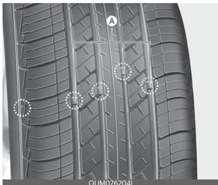
При равномерном износе шины становится виден индикатор износа (А), имеющий вид сплошной полосы. Это значит, что оставшаяся толщина протектора на шине составляет менее 1,6 мм (1/16 дюйма). В этом случае замените шину.
