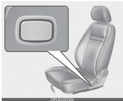
Поясничную опору можно регулировать путем нажатия на ее переключатель сбоку от сиденья.
