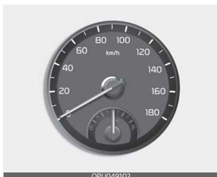
Спидометр показывает скорость автомобиля в километрах в час (км/ч).
