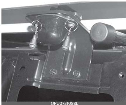
1. С помощью крестовой отвертки ослабьте винты крепления рассеивателя.
