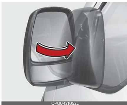
Для того чтобы сложить наружное зеркало заднего вида, возьмитесь за корпус зеркала и сложите его по направлению к задней части автомобиля.
