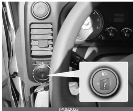
Чтобы отрегулировать уровень света фар в зависимости от числа пассажиров и веса груза в багажном отделении, поверните переключатель выравнивания света.
