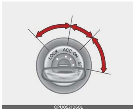
Рулевое колесо блокируется для защиты от угона. Ключ из замка зажигания можно извлечь только в положении «LOCK» (Заблокировано).
