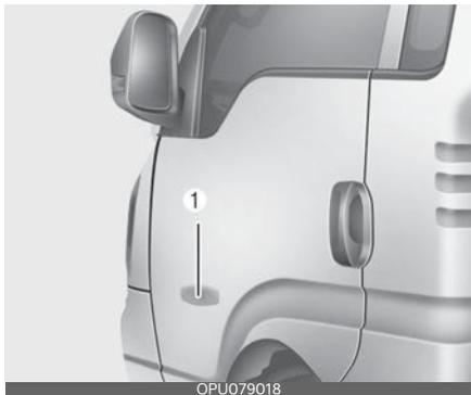
2. Боковой повторитель указателя поворота (светодиодная лампа)
