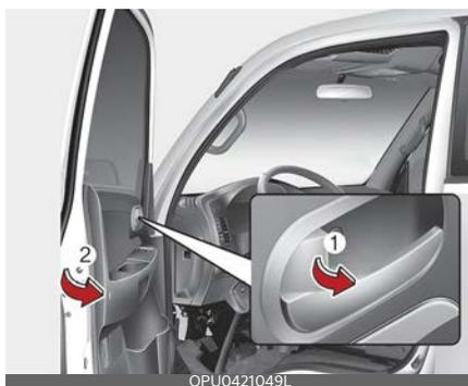
Чтобы запереть дверь без ключа, переведите внутреннюю кнопку блокировки двери (1) в положение «Блокировать» и закройте дверь (2).
