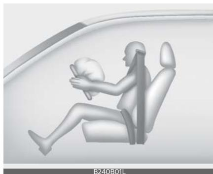
Модули фронтальных подушек безопасности располагаются по центру рулевого колеса и в передней панели над перчаточным ящиком, напротив пассажира и/или в нижней части панели со стороны водителя. Если модуль SRSCM регистрирует сильный удар в переднюю часть автомобиля, то автоматически срабатывают подушки безопасности.
