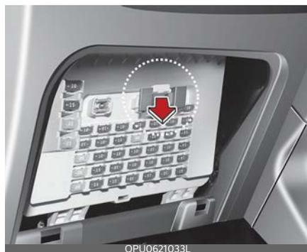
Автомобиль оснащен предохранителем памяти (1), предотвращающим разрядку аккумулятора, если автомобиль находится на стоянке и не эксплуатируется в течение длительного времени.
