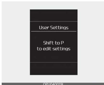
Это предупреждение появляется при попытке задать пользовательские настройки во время движения. Автоматическая трансмиссия. По соображениям безопасности пользовательские настройки можно изменять после парковки автомобиля, включения стояночного тормоза и переключения рычага передач в положение «Р» (парковка).
