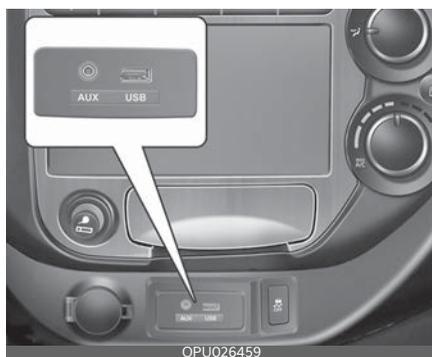
Порт AUX можно использовать для подключения звуковых устройств, а порт USB для подключения устройств USB или iPod®.
