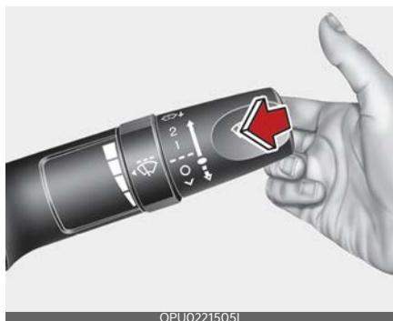
В выключенном положении (0) слегка потяните рычаг на себя, чтобы sprыснуть омывающей жидкостью лобовое стекло и запустить 1-3 цикла работы стеклоочистителей.
