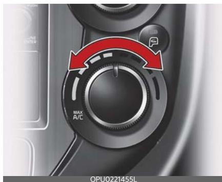
Регулятор температуры позволяет контролировать температуру воздуха, поступающего из вентиляционной системы. Для изменения температуры воздуха в салоне поверните регулятор вправо, чтоб сделать воздух теплее, или влево, чтобы сделать его холоднее.
