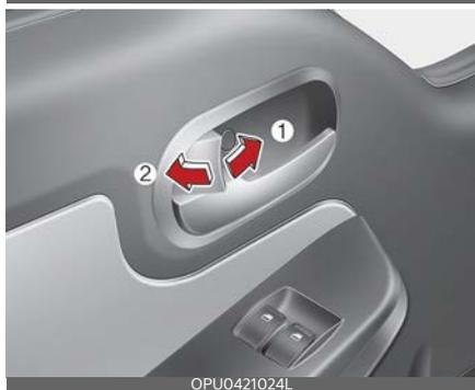
Если вы запираете (1)/отпираете (2) дверь водителя или дверь пассажира (при наличии) ключом или кнопкой блокировки, передние двери запираются/отпираются автоматически.
