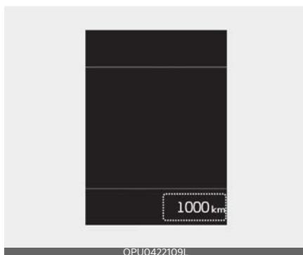
Одометр показывает общее расстояние, которое преодолел автомобиль, и предназначен для определения срока проведения периодического техобслуживания.
