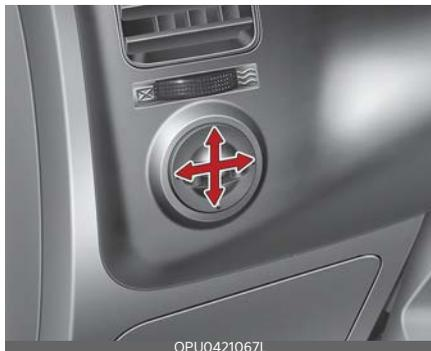
Положение левого и правого зеркала заднего вида можно дистанционно отрегулировать при помощи переключателя наружных зеркал заднего вида. Чтобы отрегулировать положение какого-либо из зеркал, выберите правое или левое зеркало, а затем нажмите на соответствующую точку (●), чтобы сместить выбранное зеркало вверх, вниз, влево или вправо.
