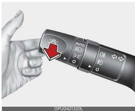
Для мигания дальним светом потяните рычаг на себя. После отпущания рычаг вернется в исходное положение (ближний свет). Для использования функции мигания включение переключателя фар головного света не требуется.
