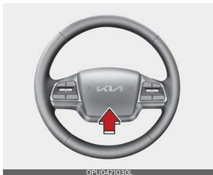
Чтобы подать звуковой сигнал, нажмите на символ гудка на рулевом колесе. Регулярно проверяйте звуковой сигнал, чтобы убедиться в его исправной работе.
