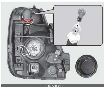
4. Извлеките лампу из патрона, вдавив ее и повернув против часовой стрелки до положения, в котором ее выступы совместятся с прорезями в патроне. Выньте лампу из патрона.
