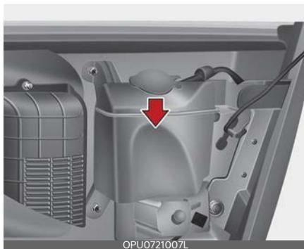
Бачок имеет прозрачный корпус, поэтому уровень жидкости можно контролировать визуально снаружи.
