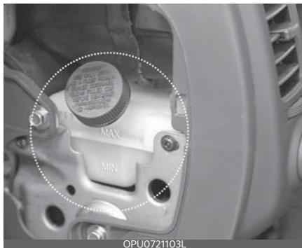
Периодически проверяйте уровень жидкости в бачке. Уровень жидкости должен находиться в пределах между отметками «MAX» (макс.) и «MIN» (мин.), нанесенными на боковой поверхности бачка.
