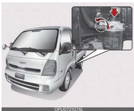
Если топливо закончилось во время движения, автомобиль не используется в течение длительного времени или выполнена замена топливного фильтра, необходимо продуть топливную систему, чтобы удалить воздух (см. рисунок).
