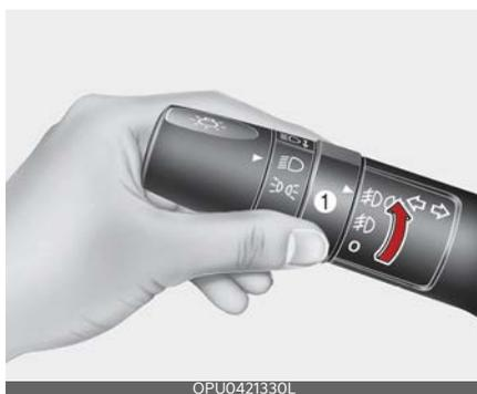
Включить задний противотуманный фонарь можно при включенных передних фарах или при включенных передних противотуманных
