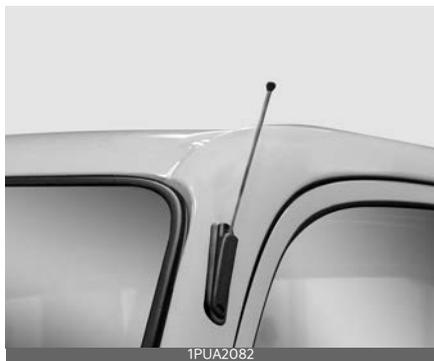
В вашем автомобиле используется ручная антенна из нержавеющей стали для приема сигналов радиостанций на частоте AM и FM. Пальцами потяните антенну вверх.
