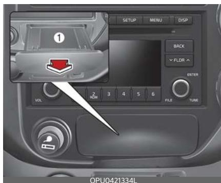
Чтобы снять пепельницу для опорожнения или очистки, нажмите на язычок (1) и полностью вытяните ее.
