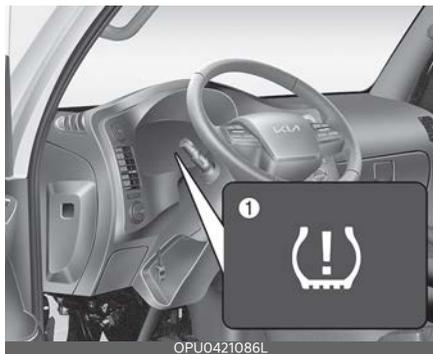
1. Сигнал низкого давления в шинах / индикатор неисправности системы TPMS.
