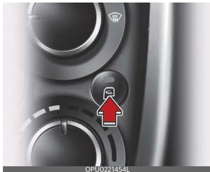
С помощью этого регулятора можно выбрать забор наружного (свежего) воздуха или режима рециркуляции. Чтобы изменить режим, нажмите кнопку управления.
