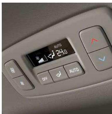
Независимое управление климатической системой для пассажиров заднего ряда
