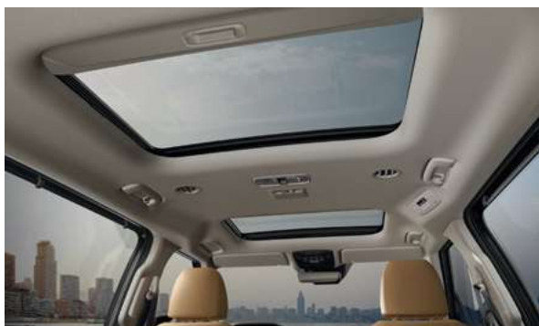
Два люка с электроприводом
