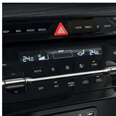
Двухзонный климат-контроль и отдельная климатическая система для пассажиров заднего ряда
