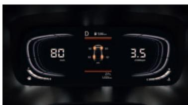
Система дистанционного контроля давления в шинах TPMS
