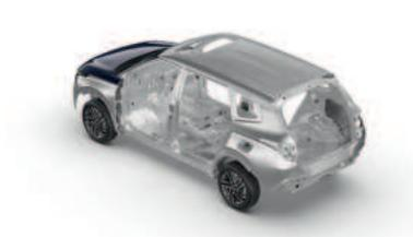
Силовая структура кузова из высокопрочных сортов стали
