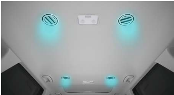
Shiftga ikkinchi va uchinchi qatorlar uchun konditsionerlash tizimining alohida havo quvurlari deflektorlari o'rnatilgan
