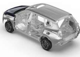
Yuqori mustahkam po'lat sortlaridan tayyorlangan kuzovning mustahkamlik tuzilmasi
