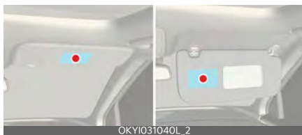
Предупреждающие наклейки подушек безопасности (Тип А)
